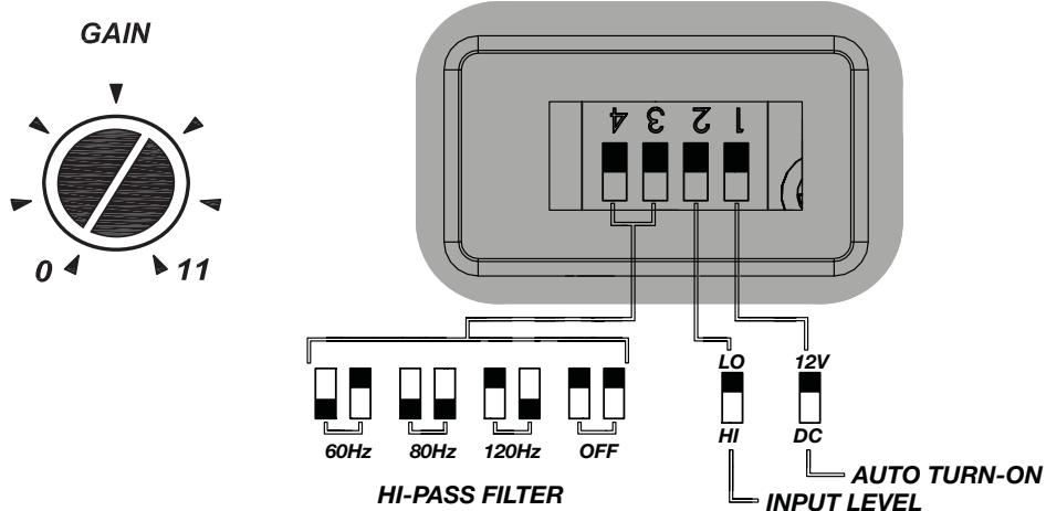
**Sélection de la mise en marche automatique :** La série PXA offre deux modes de mise en marche automatique pouvant être sélectionnés au niveau du panneau de connexion, commutateur sur +12 V ou DC offset (décalage en continu). Le mode DC offset entraîne la délivrance d'un signal +12V au niveau du connecteur REM pour l'activation d'amplificateurs supplémentaires.
