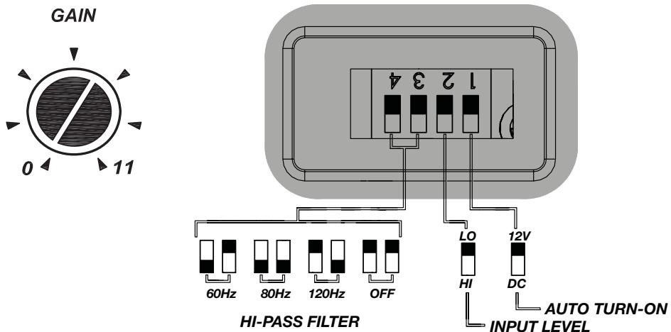
**Automatische Einschaltwahl:** Die PX-Serie umfasst drei automatische Einschaltmodi, die am Endfeld gewählt werden können: +12V oder DC Offset. Der DC Offset-Modus aktiviert am REM-Anschluss die +12V Ausgabe für das Einschalten zusätzlicher Verstärker.
