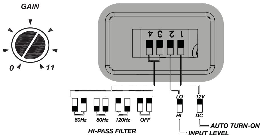
**Selección de encendido automático:** El modelo PXA ofrece dos modos de encendido automático que pueden seleccionarse en el panel terminal; desviación +12V o CD. Al usar el modo de desviación CD permite que la terminal REM tenga una salida de +12V para encender amplificadores adicionales.
