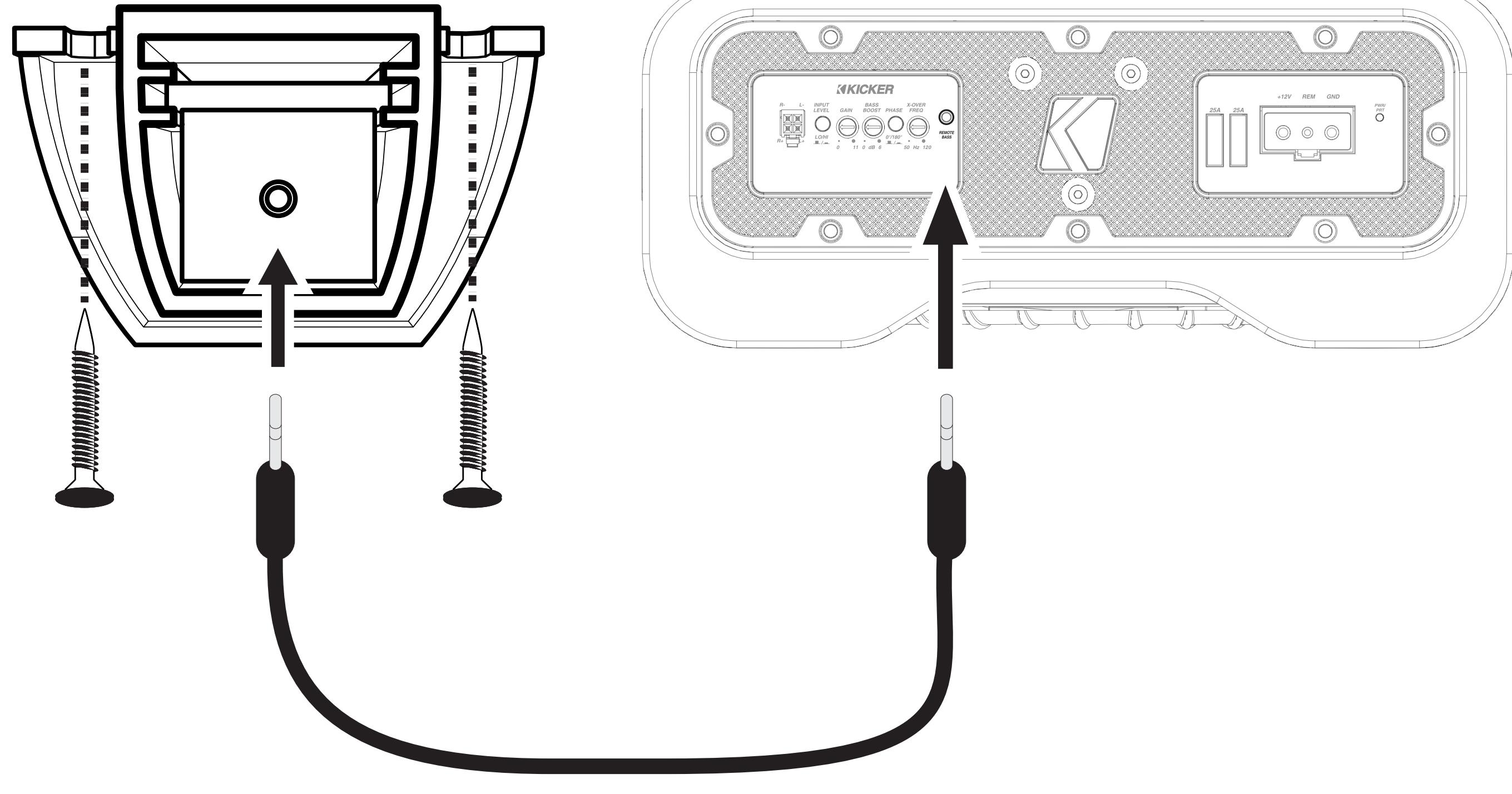
Connectez le câble à la télécommande et à la connexion Remote Bass de l'amplificateur.
