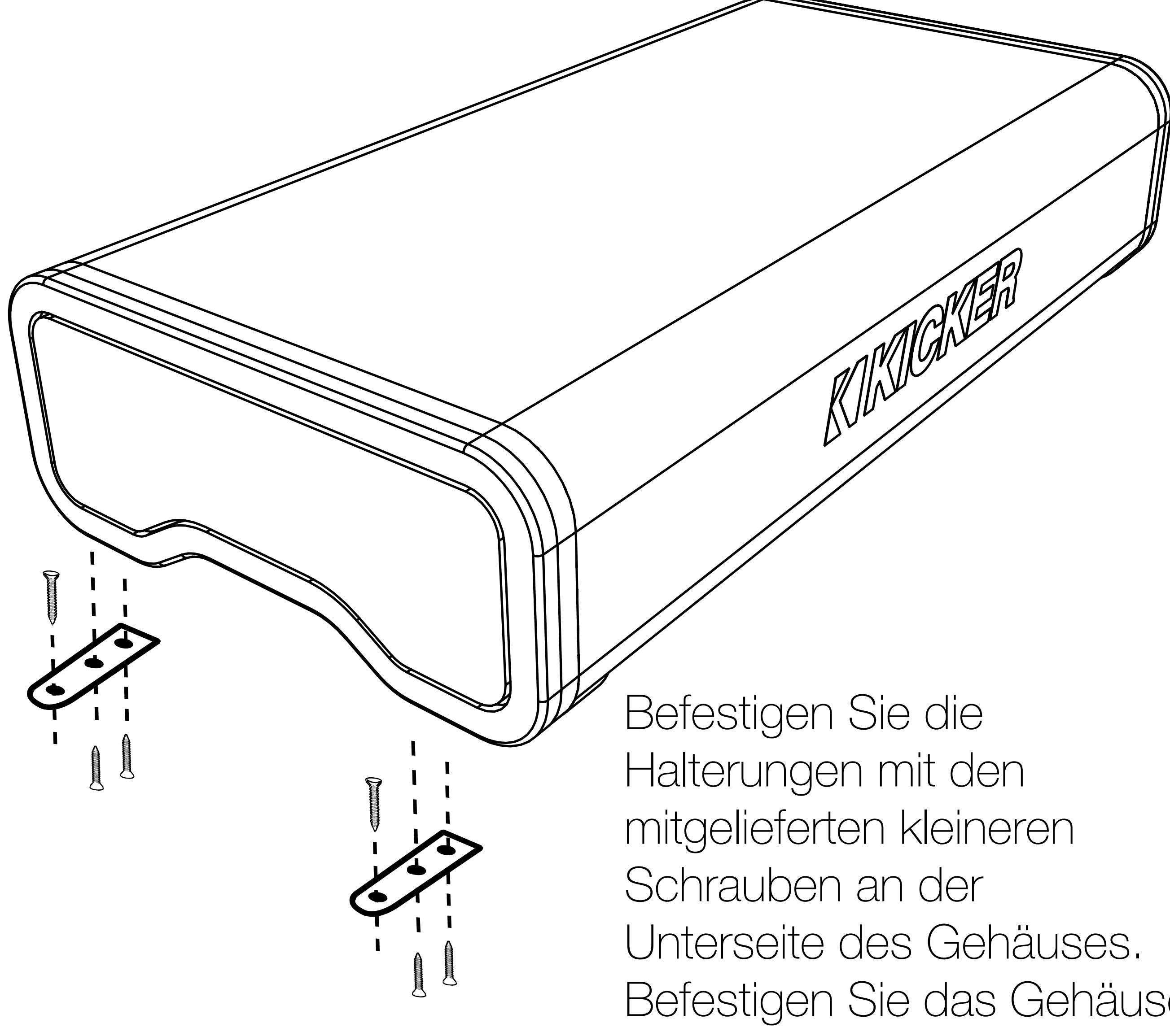
Befestigen Sie die Halterungen mit den mitgelieferten kleineren Schrauben an der Unterseite des Gehäuses. Befestigen Sie das Gehäuse mit den mitgelieferten größeren Schrauben sicher am Fahrzeug.
