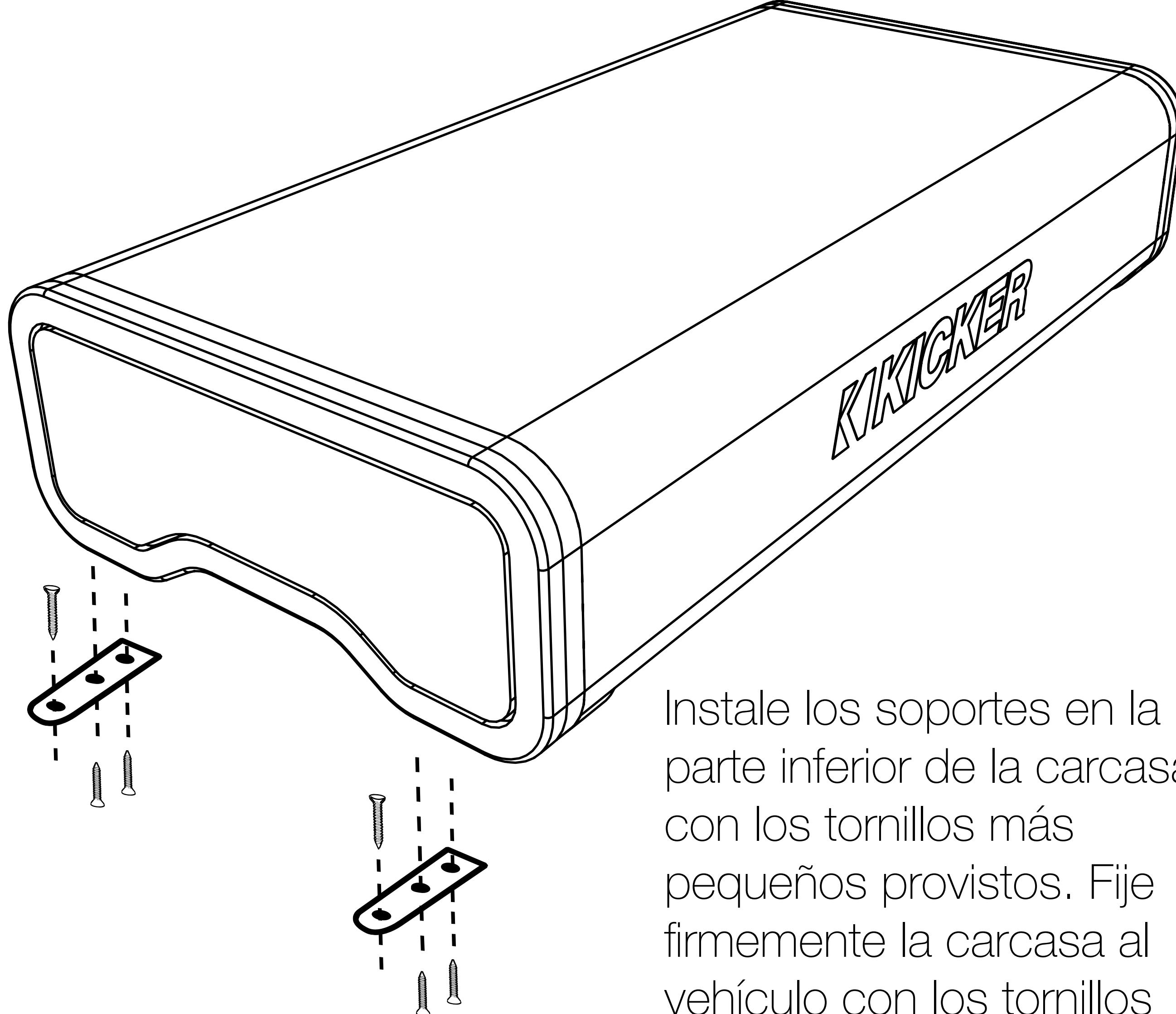
Instale los soportes en la parte inferior de la carcasa con los tornillos más pequeños provistos. Fije firmemente la carcasa al vehículo con los tornillos más grandes provistos.
