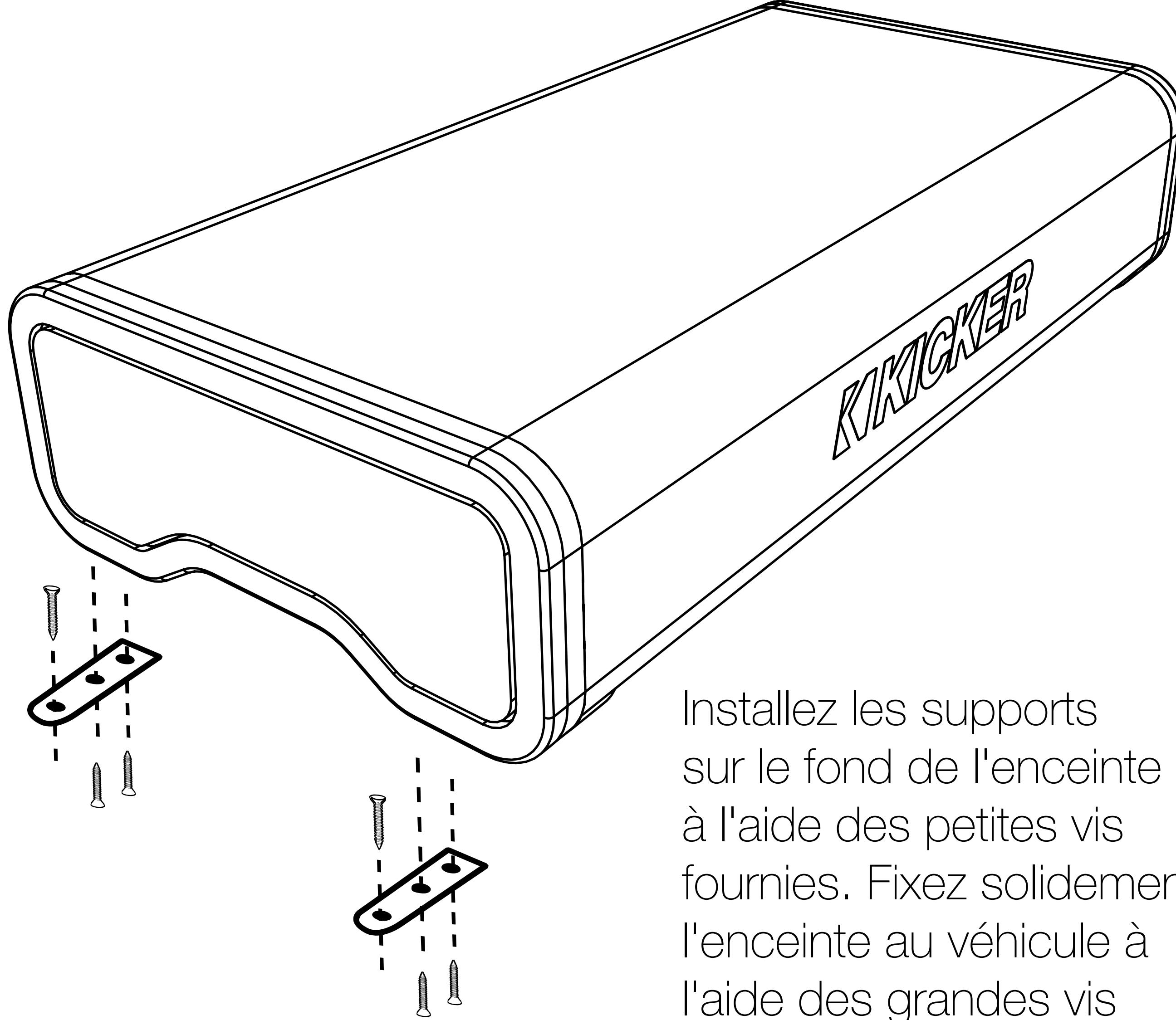
Si les accessoires de fixation fournis ne conviennent pas à votre installation, veuillez utiliser un autre moyen de fixer solidement l'enceinte au véhicule.
