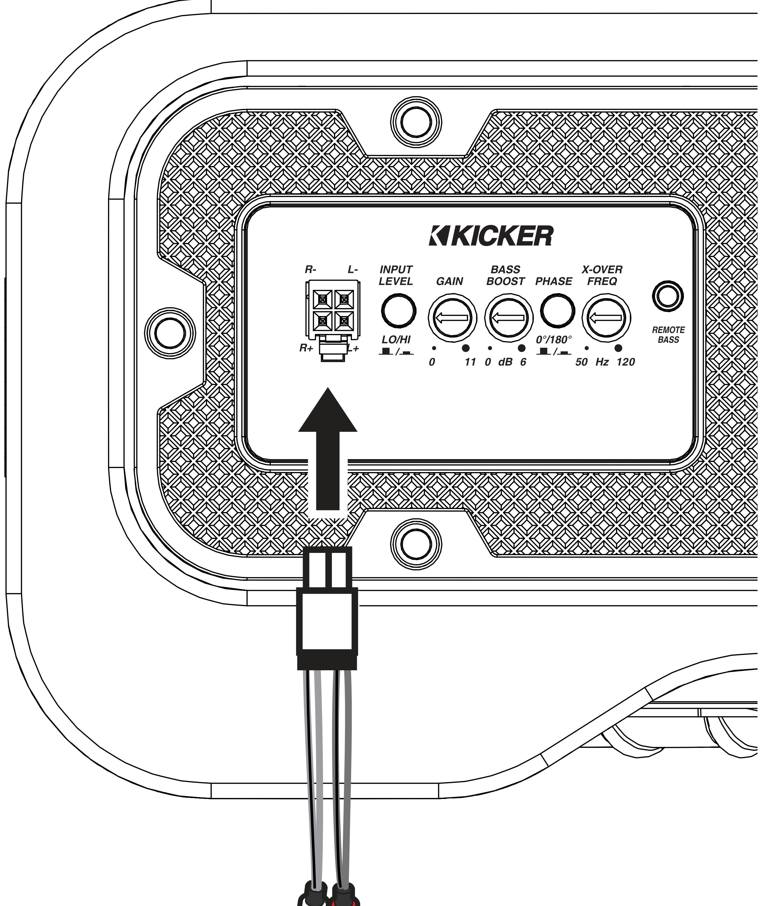
Schneiden Sie bei Bedarf die Cinch-Anschlüsse ab, um einen Hochpegel-Eingang zu verwenden, oder verwenden Sie den [KICKER-KISL Speaker-RCA Converter](#).
