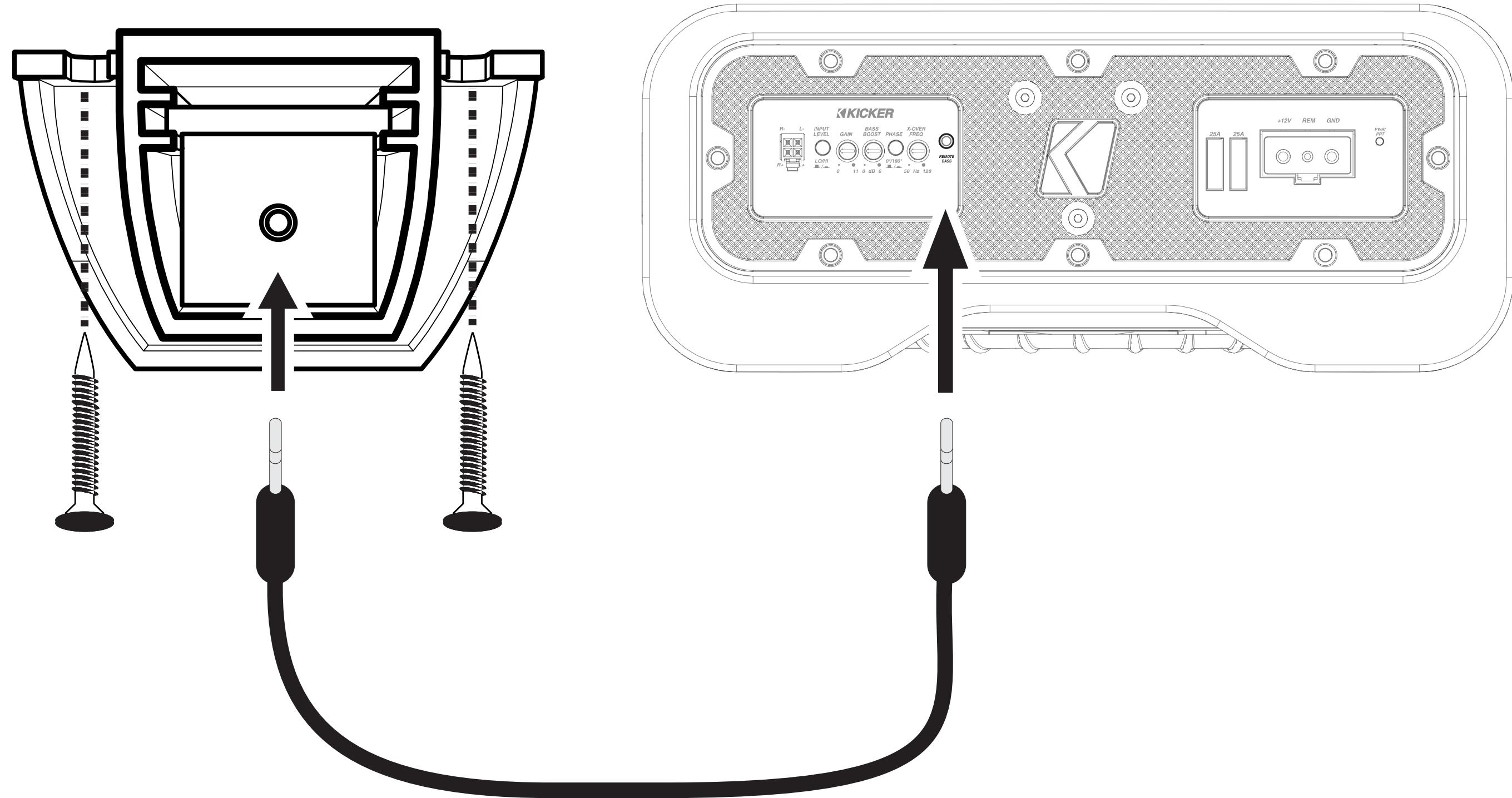
Verbinden Sie das Kabel mit der Fernbedienung und dem Anschluss „Remote Bass“ am Verstärker.
