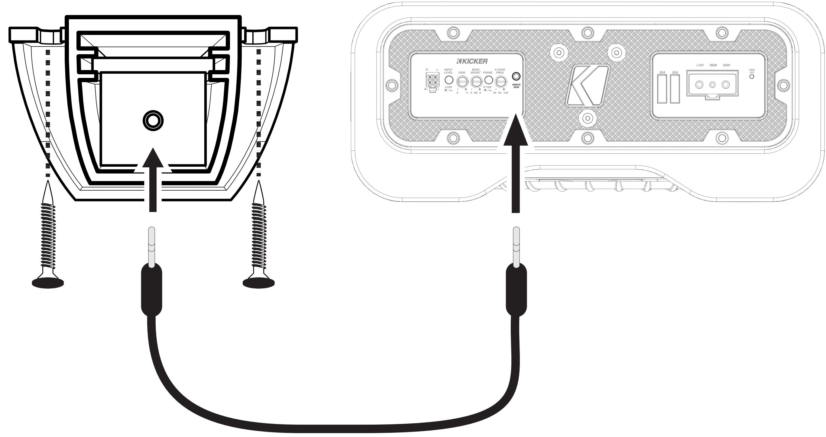
Conecte el cable al control remoto y la conexión del control remoto de graves en el amplificador
