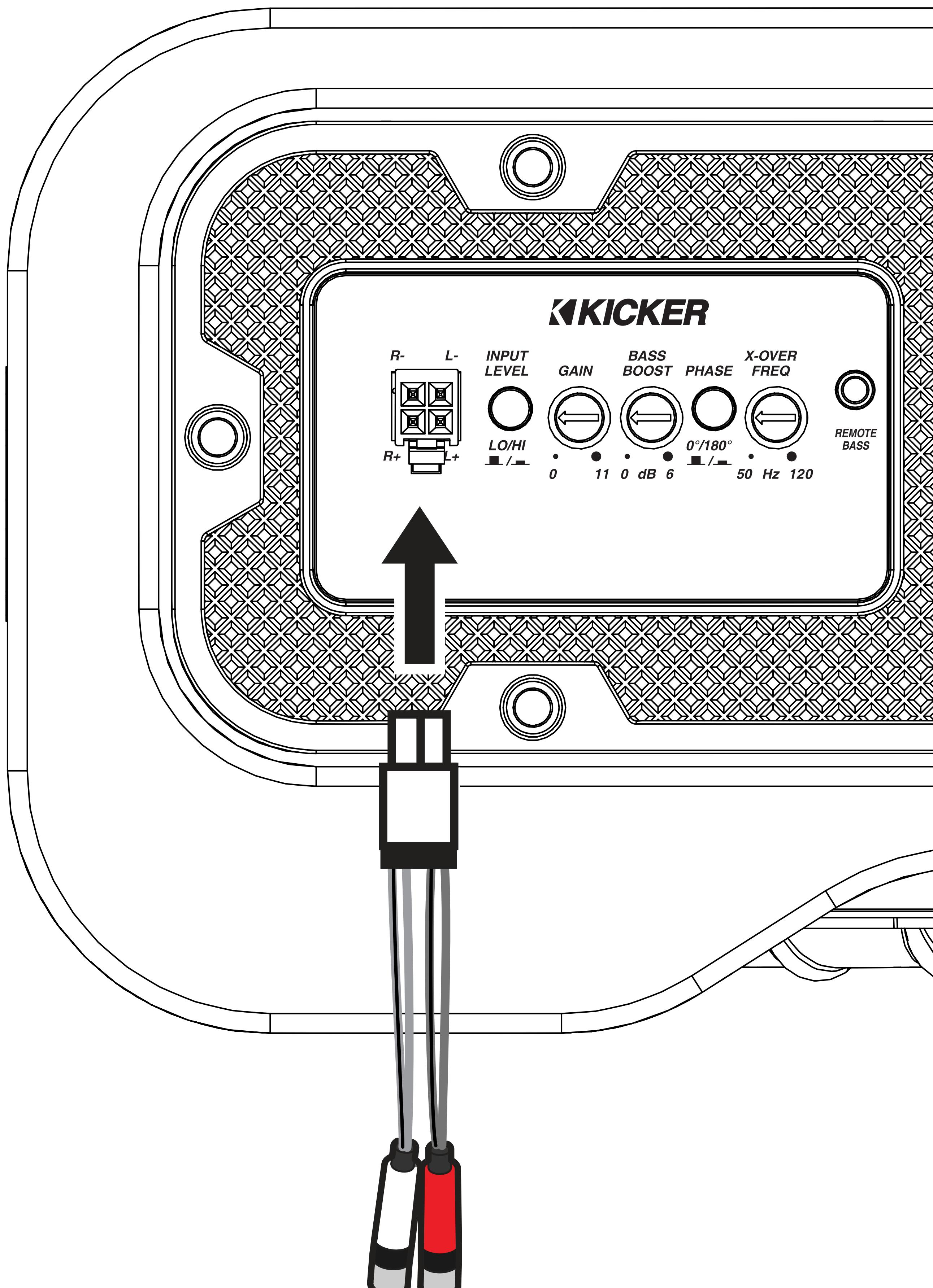
Si es necesario, desconecte las conexiones RCA para usar la entrada de nivel alto, o use el [Convertidor de salida de altavoz a RCA KISL de KICKER](#).
