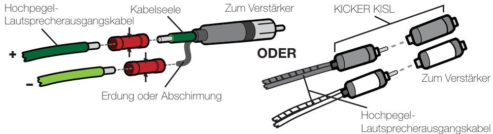
Installieren Sie in maximal 18 cm Entfernung von der Batterie eine Sicherung in Reihe mit dem Stromkabel zum Verstärker. Verwenden Sie bei der Installation von Verstärkern in Schiffsanwendungen nur KICKER KMPK-Verkabelungssätze oder anderes Original-KICKER-Schiffszubehör.
