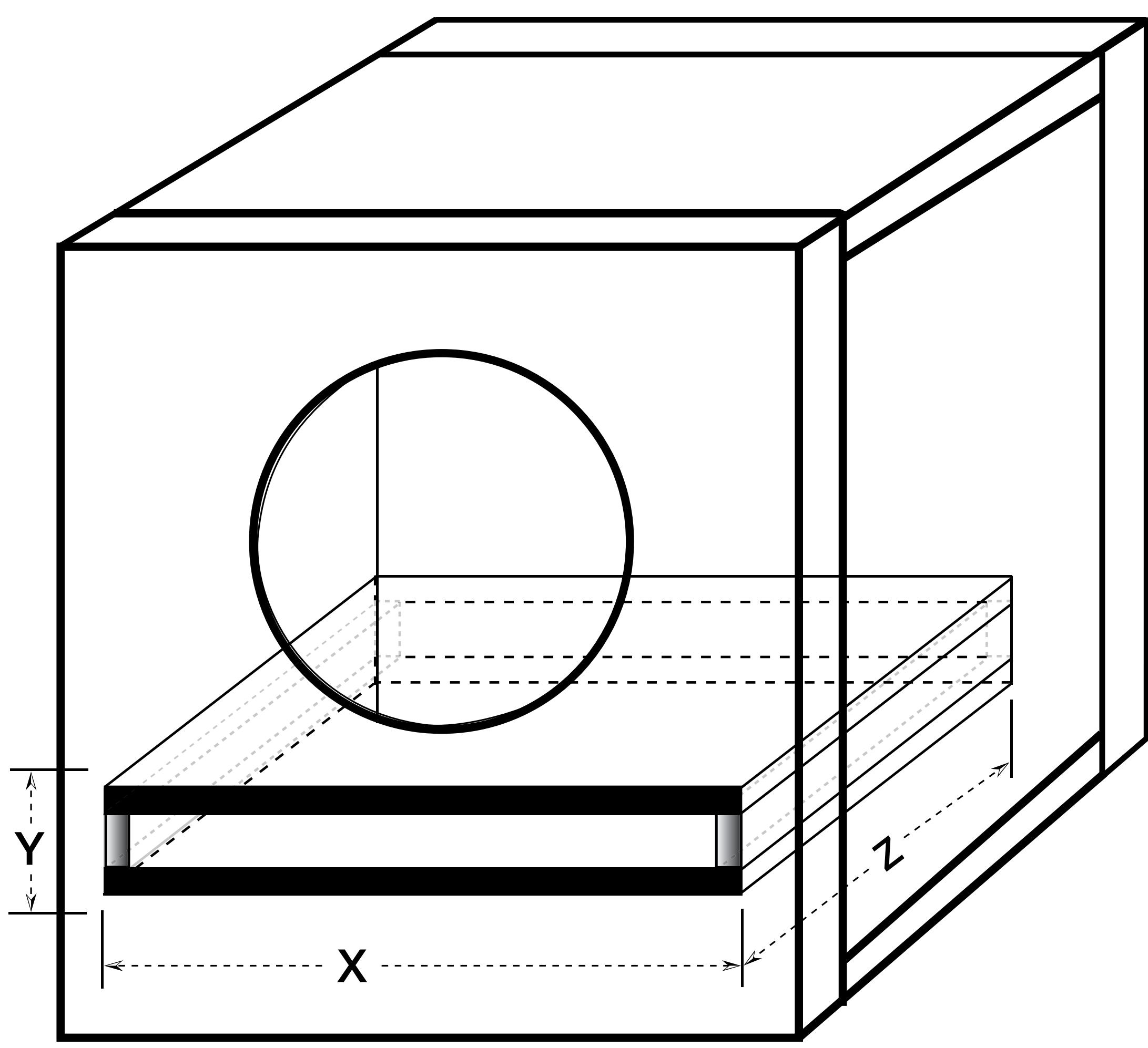
N'installez pas d'ouverture de port contre une surface solide, comme un support interne, un panneau arrière ou une paroi du coffre, un siège ou un panneau intérieur de votre véhicule. L'ouverture du port doit rester dégagée. Utilisez la plus petite dimension du port rectangulaire comme quantité d'espace minimum entre l'ouverture du port et toute surface solide pour assurer la circulation d'air sans restriction.
